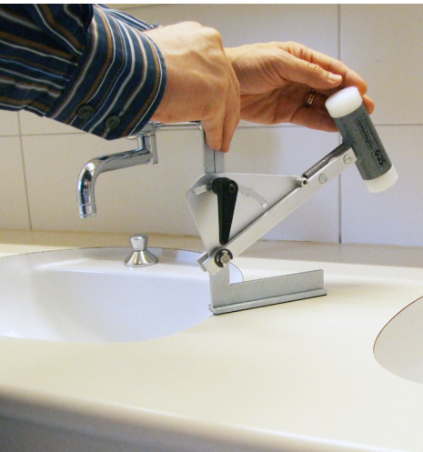
EMPA-Pendelfallhammer für die einheitliche Erzeugung von Benutzergeräuschen (Einzelgeräusche), hier bei einem Badmöbel
